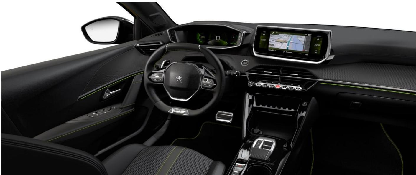
PEUGEOT i-Cockpit® 3D: Υπερυψωμένος 3D ψηφιακός πίνακας οργάνων 10" υψηλής ανάλυσης / Έγχρωμη οθόνη αφής 10" HD στο κέντρο του ταμπλό / Τιμόνι μικρής διαμέτρου με δερμάτινη επένδυση και ενσωματωμένα χειριστήρια / Διακόπτες αεροπορικού τύπου
