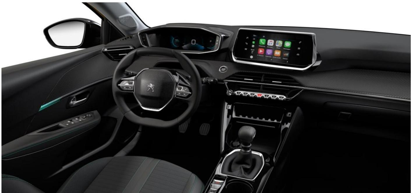
PEUGEOT i-Cockpit® 3D: Υπερυψωμένος 3D ψηφιακός πίνακας οργάνων 10" υψηλής ανάλυσης / Έγχρωμη οθόνη αφής 7" SD στο κέντρο του ταμπλό / Τιμόνι μικρής διαμέτρου με δερμάτινη επένδυση και ενσωματωμένα χειριστήρια / Διακόπτες αεροπορικού τύπου
