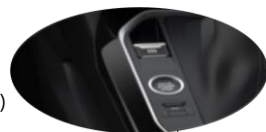
Κουμπί εκκίνησης κινητήρα (ENGINE START/STOP button)
